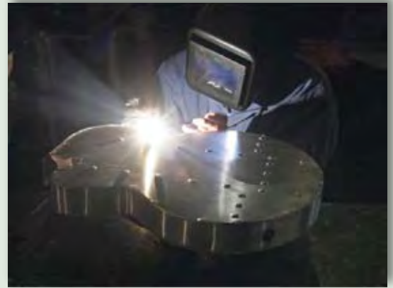
Soldagem das laterais do corpo da guitarra
