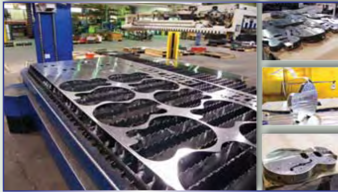
Corpo de uma guitarra de alumínio em diferentes etapas de sua fabricação
